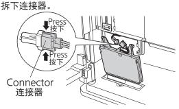
Installing 安装方法
